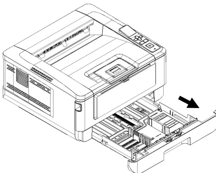
**4** Нажмите на фиксатор (1) ограничителя ширины (2), а затем переместите ограничитель ширины (2) в положение, соответствующее формату загружаемой бумаги.
