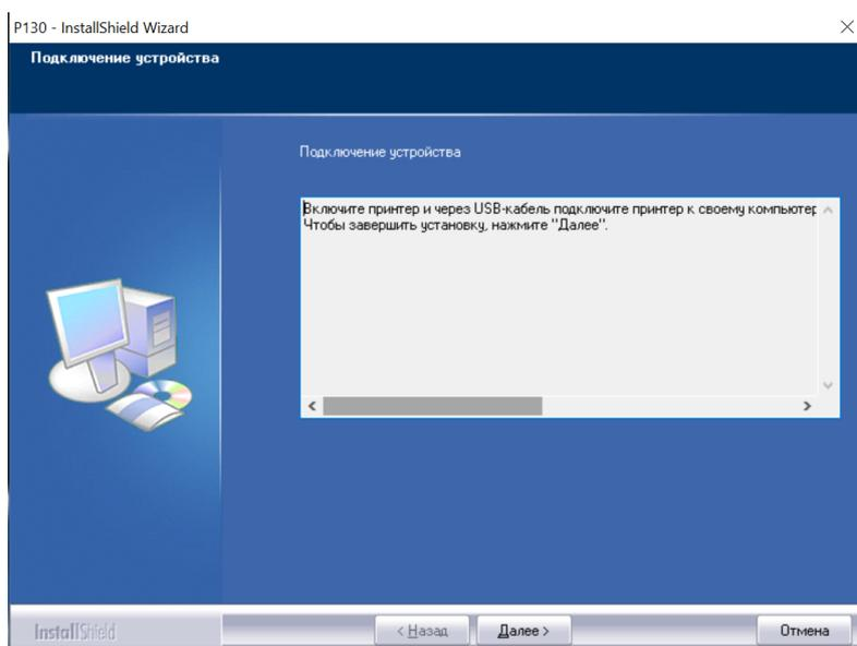
**6** Подключите один конец USB-кабеля к компьютеру, а другой его конец к USB-порту устройства.
