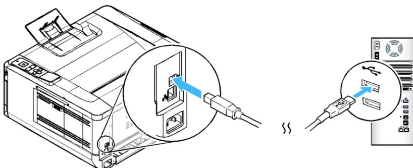
**6** После подключения принтера к компьютеру по USB-кабелю нажмите кнопку [Далее >] и следуйте инструкциям на экране, чтобы завершить установку.
