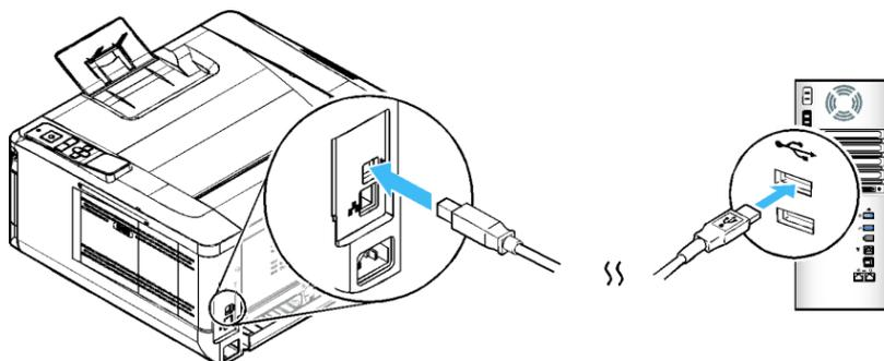
**7** После подключения принтера к компьютеру по USB-кабелю нажмите кнопку [Далее >] и следуйте инструкциям на экране, чтобы завершить установку.
