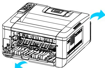
2. Откиньте вниз выходную направляющую узла термозакрепления.
