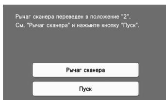
Если выполнить сканирование с поднятым рычагом, изображение может получиться размытым.
