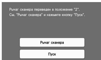
Если выполнить сканирование с поднятым рычагом, изображение может получиться размытым.
