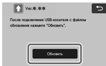
► После завершения обновления машина автоматически перезагружается.
