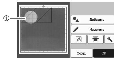
① Материал с вырезом отображается в качестве фона
