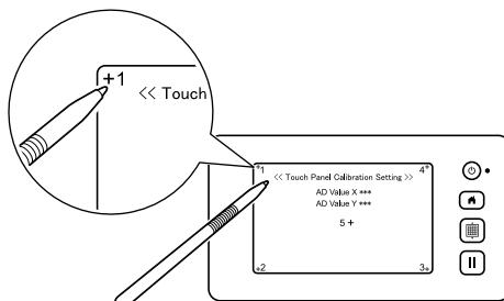
► Когда регулировка сенсорной панели будет завершена, на экране отобразится сообщение “SUCCESS”.
