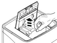
Если в аппарате происходит замятие бумаги, которое невозможно устранить, откройте крышку слота для автоподачи, затем загорится индикатор открытой дверцы, аппарат перестанет работать, а затем удалите лишние листы, чтобы количество не превышало заявленного в инструкции.
