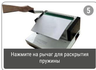
Нажмите на рычаг для раскрытия пружины
