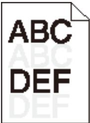
Решение : 1) Возможно, картридж с тонером поврежден. Замените используемый картридж на новый.
