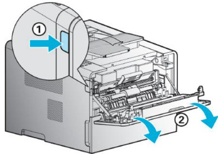
3 Выньте картридж из устройства, а затем нажмите кнопку удаления картриджа с тонер (①) и извлеките полностью использованный картридж (②). Утилизируйте старый картридж в соответствии с установленными нормами.
