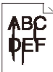
Решение: 1) Возможно, не хватает тонера. Чтобы использовать оставшийся тонер, снимите картридж и слегка встряхните его, а затем установите снова.
