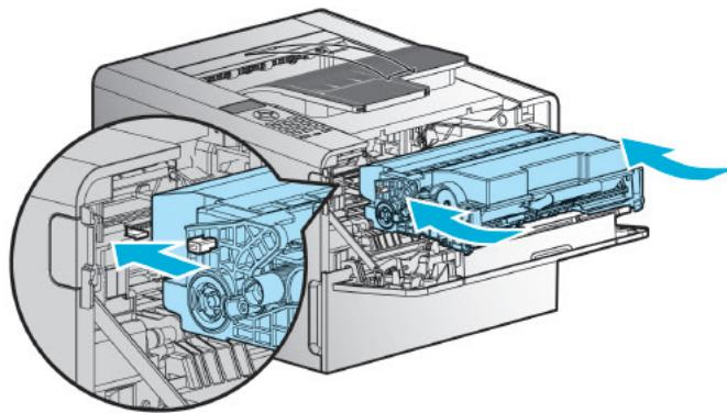
9 Переустановите счетчик барабана картриджа после его замены. Для переустановки счетчика см. приложенную к новому барабану картриджу инструкцию.
